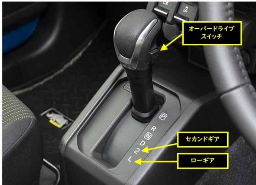
オーバードライブスイッチをOFFにすると、メーターに表示灯が点灯します。
