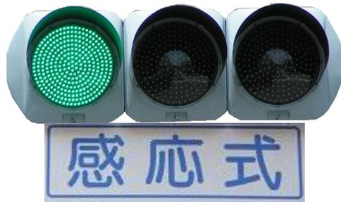
停止線手前の上空にセンサーが設置されていて、自動車の停止を感知し、一定時間経過後に信号を青にする信号機です
